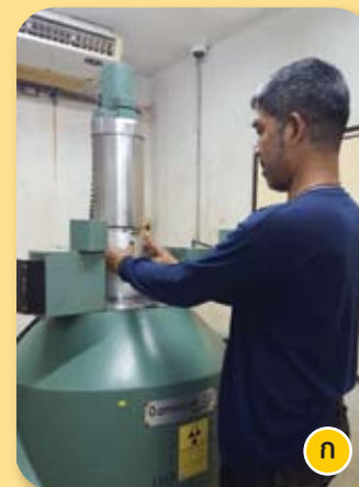
ภาพที่ 28 การฉายรังสีดักแด้แมลงวันผลไม้ ก) ฉายรังสีดักแด้แมลงวันผลไม้ด้วยเครื่องฉายรังสีแกมมาเชล 220 ข) บรรจุดักแด้ฉายรังสีส่งไปยังพื้นที่
