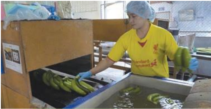
การลดความชื้น โดยใช้อุโมงค์เป่าลม
