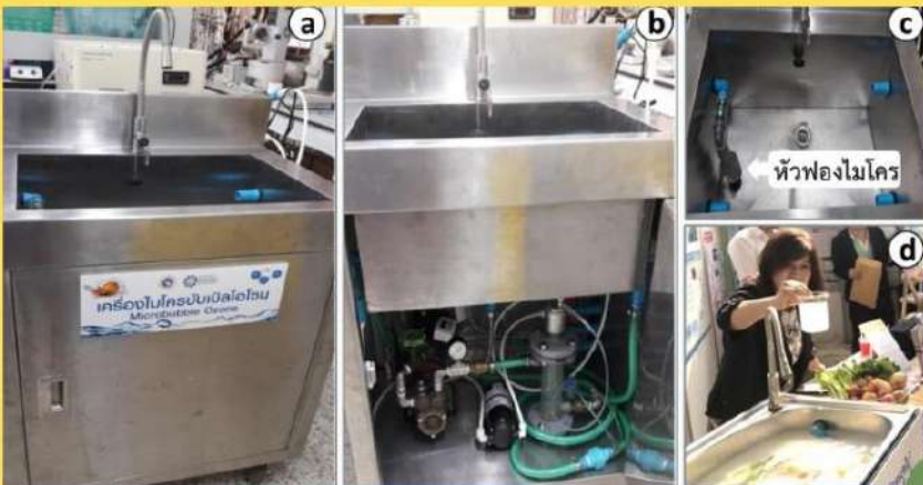
ภาพ 1 เครื่องต้นแบบล้างผักระบบไมโครบับเบิลร่วมกับโอโซนขนาด 60 ลิตร จากลักษณะด้านนอก (a) ด้านในที่ประกอบด้วยระบบไมโครบับเบิลที่สามารถเชื่อมต่อกับเครื่องผลิตโอโซน (b) ลักษณะอ่างที่มีระบบหมุนเวียนน้ำ (c) และลักษณะน้ำจากที่มีลักษณะขุ่นขาวสามารถนำไปใช้ในการล้างผักผลไม้ (d)
